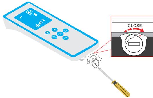
5. 安装上电池盖，从红色位置开始，到绿色位置结束，电池塞要安装到底否者可能遥控进水或者接触不良，影响使用。
