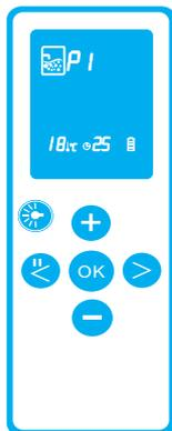
7. 选择好温度显示方式按确认键OK进入遥控功能待机界面如图所示。
