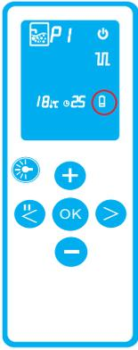
1. 如图所示当电池电量低的时候需要更换电池
