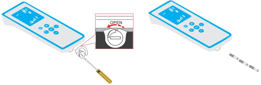
2. 用平口螺丝刀打开遥控底部的电池塞如图所示，逆时针旋转即可。
