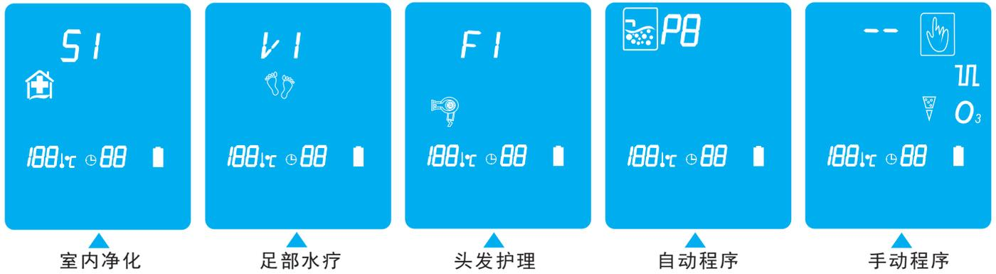
步骤2. 选择自己需要的程序然后按OK键确认程序机器开始运行，这时屏幕右上角有电源标识 表示激活本程序。
